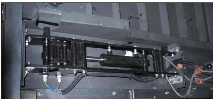
L'Actuateur 7818-01-A1 installé sur une rampe.
