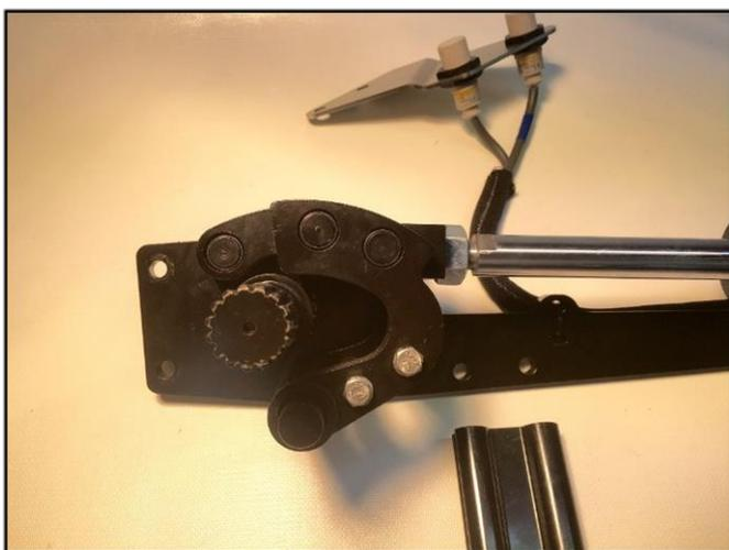
Vue du mécanisme d'entraînement à quatre pivots.
